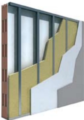
Controparete ad orditura metallica autoportante
